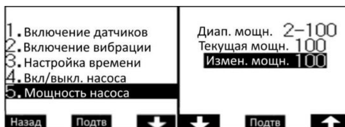
Рис. 10. Настройка мощности прокачки насоса
